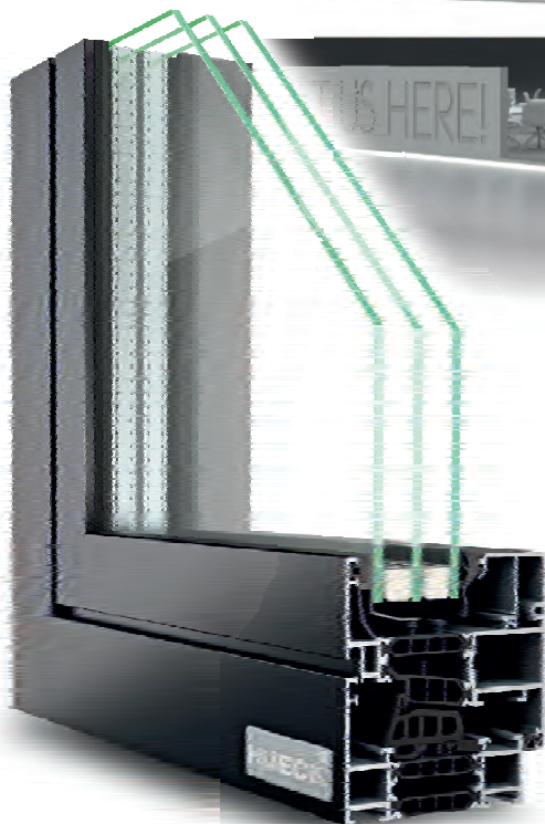
Fenstersystem Hueck Lambda WS 075 mit nur 75 mm Bautiefe und schmaler Profilansicht sowie Wärmedämmung nach den Vorgaben der Energiesparverordnung EnEV 2016.
